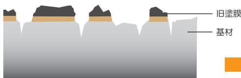
経年の熱、紫外線、雨などにより劣化が進行し、表面が脆弱化した状態。
